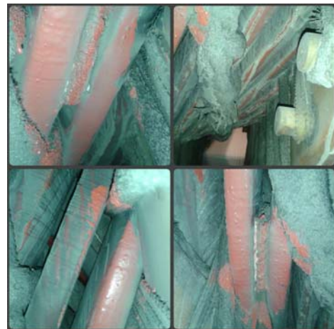
شکل ۱۰: آلودگی‌های قسمت انتهایی سیم پیچ ژنراتور قبل از دوره اورهال
