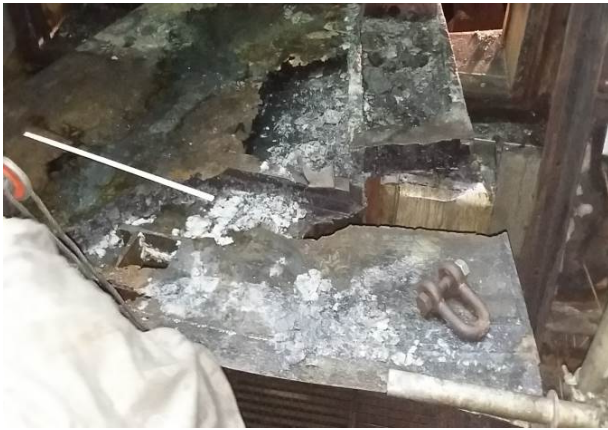
شکل ۴ سکتور پلیت آسیب دیده در مسیر دود خروجی ایرهیتر
