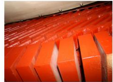
شکل (2): برجستگی‌های پرز مانند بر روی شیشه استاتور
