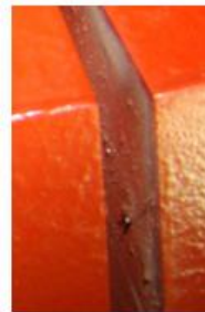
شکل (2): برجستگی‌های پرز مانند بر روی شیشه استاتور
